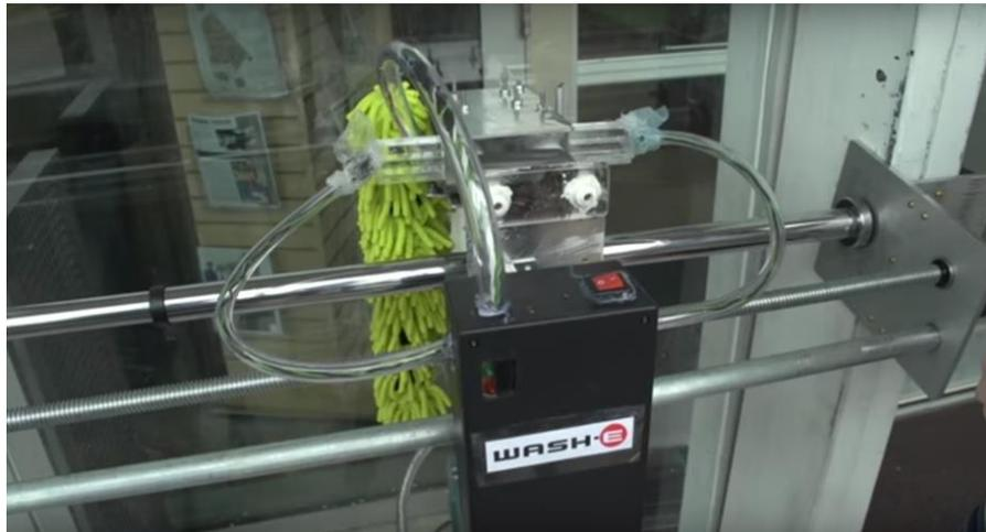
El prototipo trabaja solo de forma horizontal en distintos modos de velocidad para así asegurar la limpieza del vidrio.
