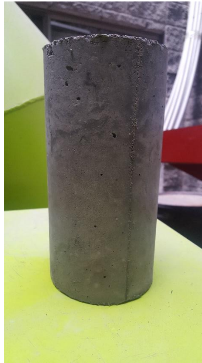
Imagen 6. Cilindro de Concreto con 20% de Hueso Triturado. Fuente: Propia.
