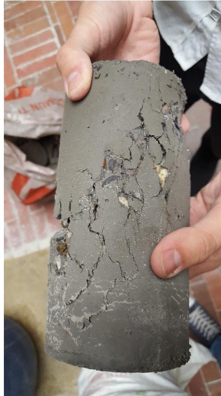
Imagen 10. Forma de la Falla Transversal de un Cilindro con 30% de Agregado de Hueso Triturado. Fuente: Propia.
