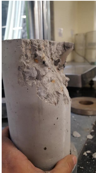
Imagen 13. Tipo de falla del cilindro 5 con 10% de agregado de hueso triturado. Fuente: Propia
