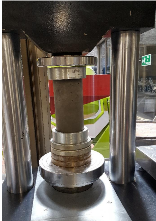
Imagen 9. Montaje del Cilindro de Concreto con 10% de Agregado de Hueso Triturado.
