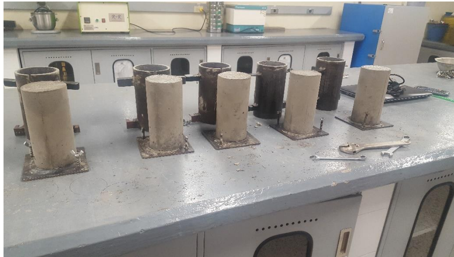
Imagen 7. Desencofrado de los cilindros de concreto. Fuente: Propia.
