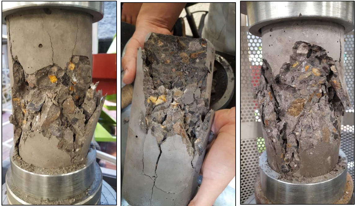
Imagen 12. Tipos de fallas de cilindros de concreto convencional 7 días (Izquierda), 14 días (Centro), 28 días (Derecha). Las imágenes mostradas corresponden a los cilindros de concreto convencional Fuente: Propia
