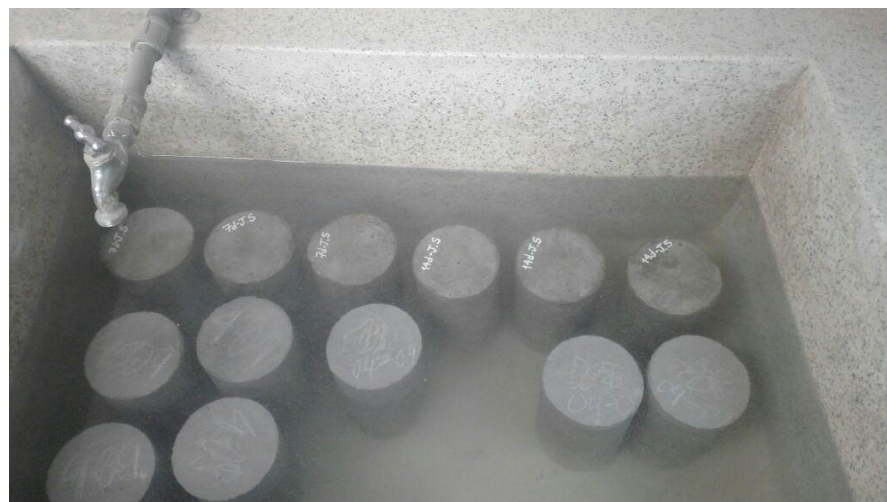
Imagen 8. Curado de especímenes de concreto con 30% de hueso triturado de reemplazo como agregado grueso. Fuente: Propia.
