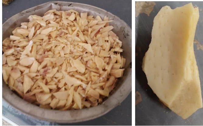
Imagen 5: Estado del hueso después de la exposición del material al cloro. Fuente: Propia
