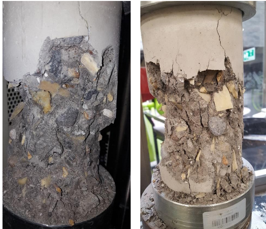
Imagen 17. Tipo de fallas de cilindros de concreto con 20% de hueso triturado a 14 días (Izquierda) y a 28 días (Derecha). Fuente Propia.
