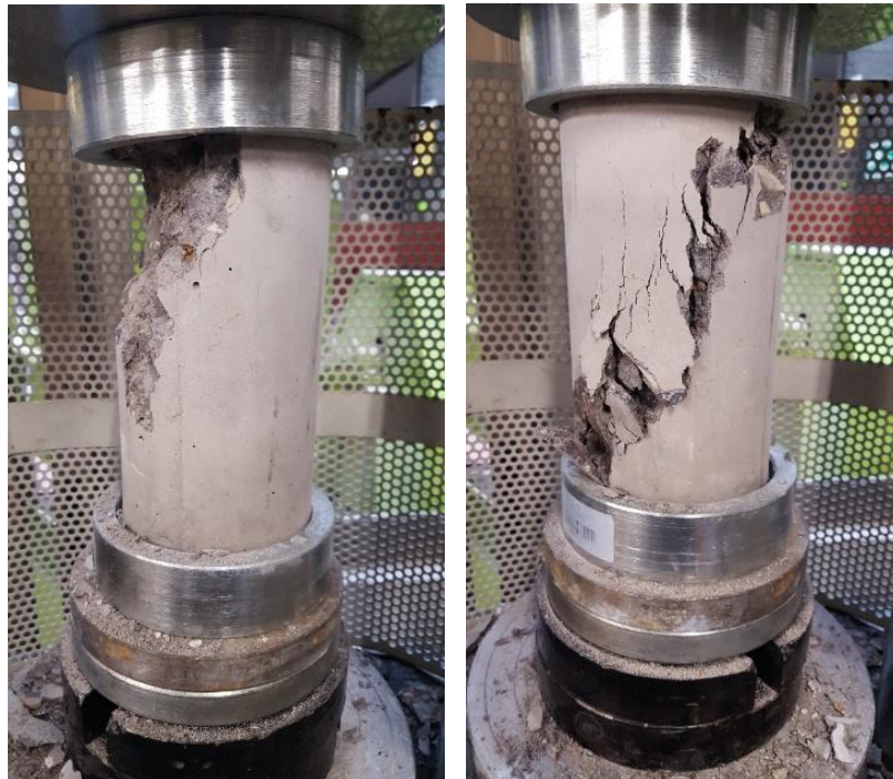
Imagen 15. Tipo de fallas de cilindros de concreto con 10% de hueso triturado a 28 días. Fuente Propia.
