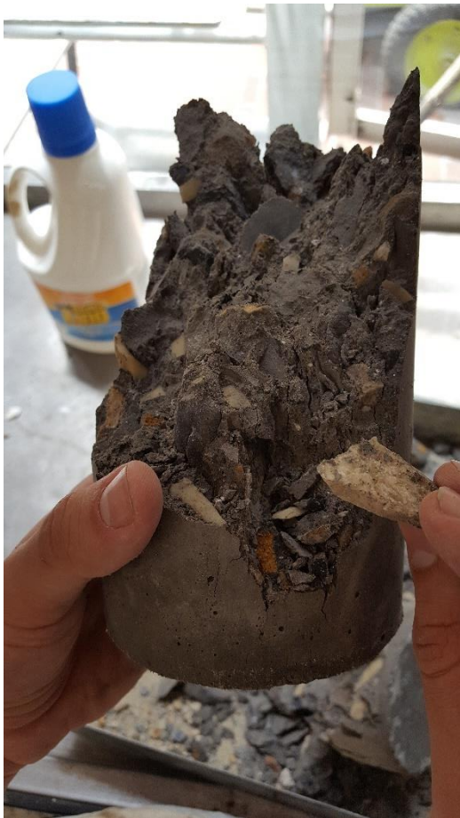
Imagen 16. Tipo de falla del cilindro 4 con 20% de hueso triturado (7 Días). Fuente: Propia
