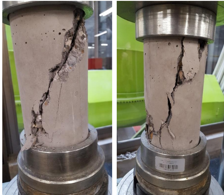
Imagen 14. Tipo de fallas de cilindros de concreto con 10% de hueso triturado a 14 días. Fuente Propia.
