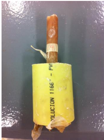
Figura 31 Conjunto 4 Suelo/Resina después del ensayo. Fuente: Autora
