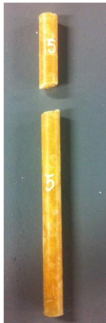
Figura 18 Espécimen 5 después del ensayo mecánico de tensión. Fuente: Autora
