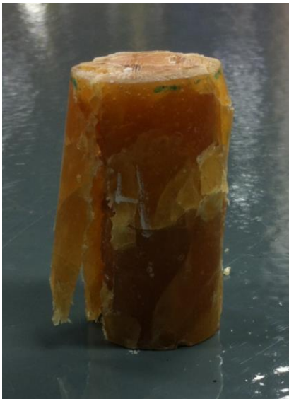
Figura 23 Espécimen 4 después del ensayo mecánico de compresión. Fuente: Autora
