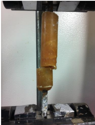
Figura 12 Ensayo de tensión en especímenes con barras. Fuente: Autora
