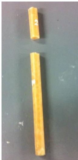
Figura 15 Espécimen 2 después del ensayo mecánico de tensión. Fuente: Autora
