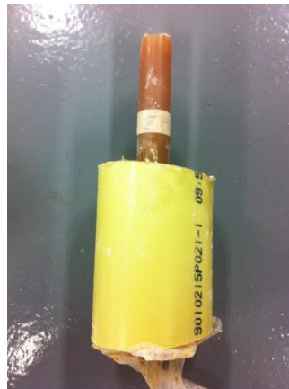
Figura 30 Conjunto 3 Suelo/Resina después del ensayo. Fuente: Autora
