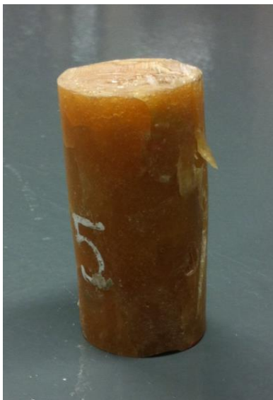
Figura 24 Espécimen 5 después del ensayo mecánico de compresión. Fuente: Autora
