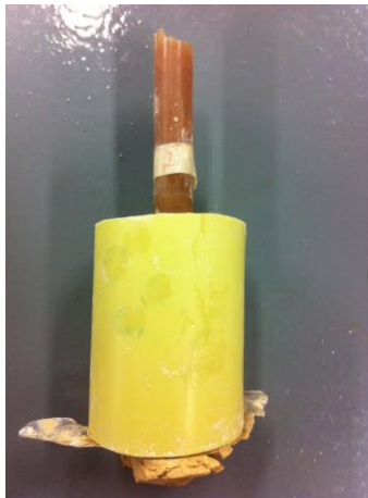
Figura 29 Conjunto 2 Suelo/Resina después del ensayo. Fuente: Autora
