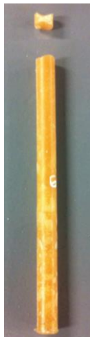
Figura 19 Espécimen 6 después del ensayo mecánico de tensión. Fuente: Autora
