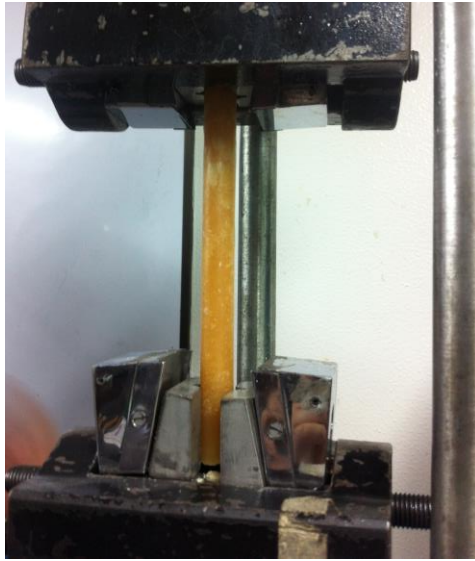
Figura 14 Espécimen para ensayo de tensión ajustado en máquina. Fuente: Autora
