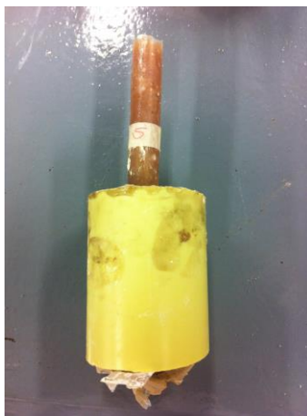
Figura 32 Conjunto 5 Suelo/Resina después del ensayo. Fuente: Autora
