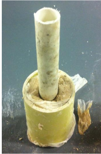
Figura 25 Molde para inyección de resina en el suelo. Fuente: Autora
