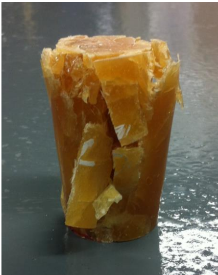
Figura 22 Espécimen 3 después del ensayo mecánico de compresión. Fuente: Autora
