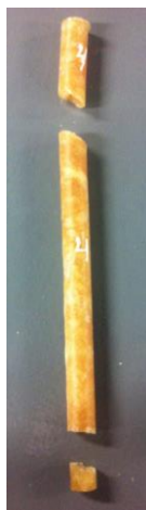
Figura 17 Espécimen 4 después del ensayo mecánico de tensión. Fuente: Autora
