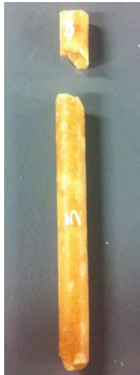
Figura 16 Espécimen 3 después del ensayo mecánico de tensión. Fuente: Autora
