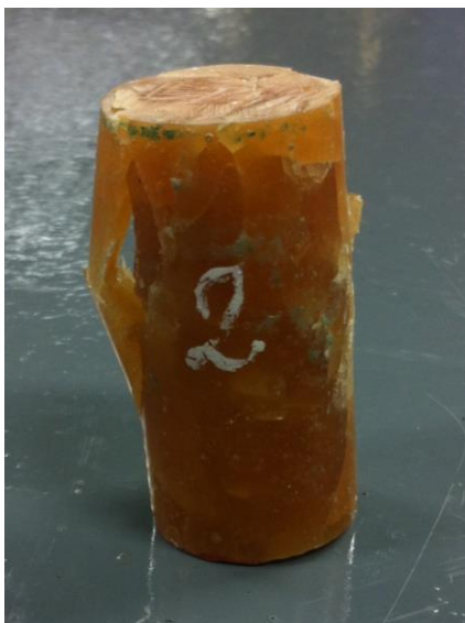
Figura 21 Espécimen 2 después del ensayo mecánico de compresión. Fuente: Autora
