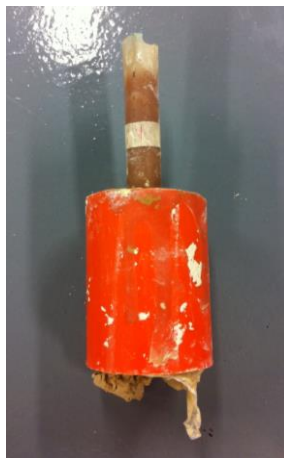
Figura 28 Conjunto 1 Suelo/Resina después del ensayo. Fuente: Autora
