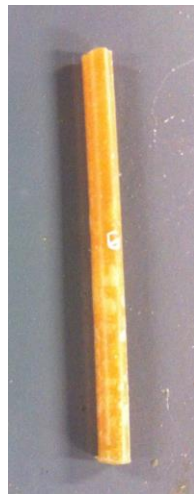
Figura 13 Especímenes definitivos para ensayos de tensión. Fuente: Autora
