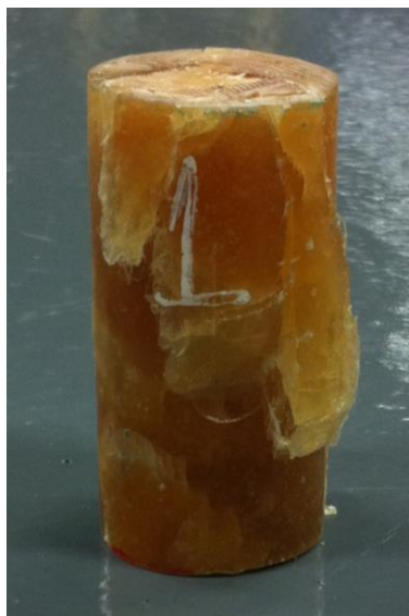
Figura 20 Especimen 1 después del ensayo mecánico de compresión. Fuente: Autora
