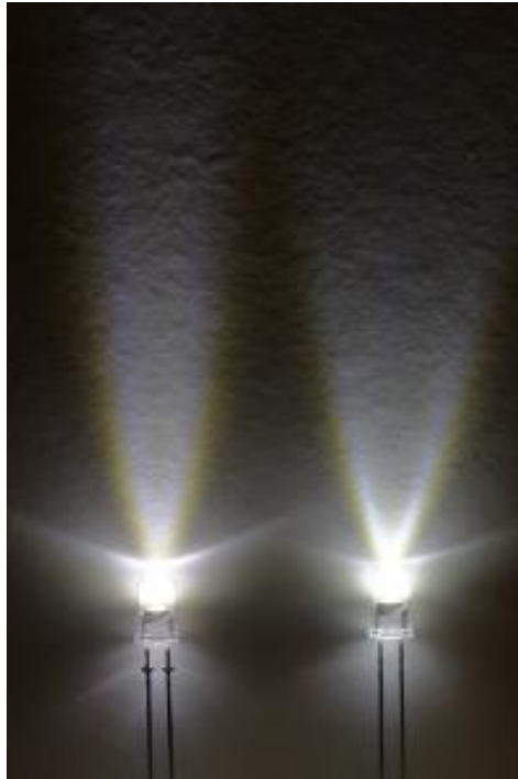
Figura 24. Diferencia de intensidad luminosa entre dos led
