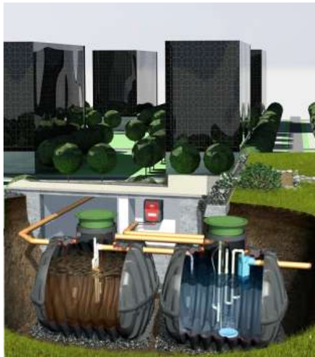
Figura 50. Sistema de tratamiento de aguas servidas del ecobarrio
