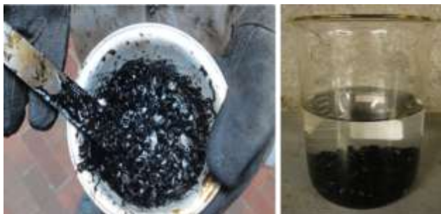
Figura 25. Ensayo de Cubrimiento de los Agregados con Materiales Asfálticos.
