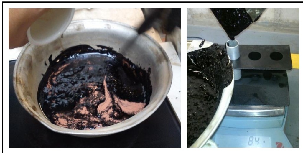
Figura 16. Ensayo de Viscosidad Rotacional (Preparación de las muestras).
