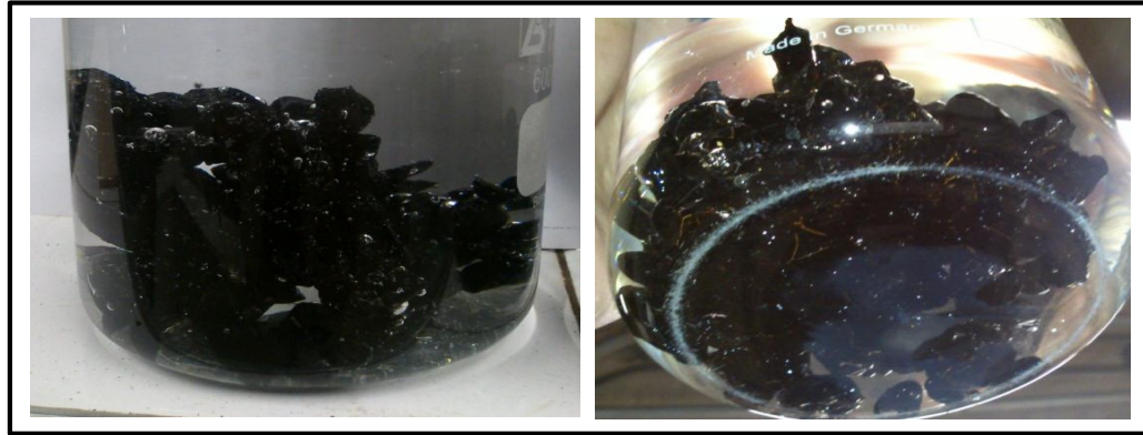
Figura 26. Ensayo de Stripping con asfalto 80-100 + GCR.
