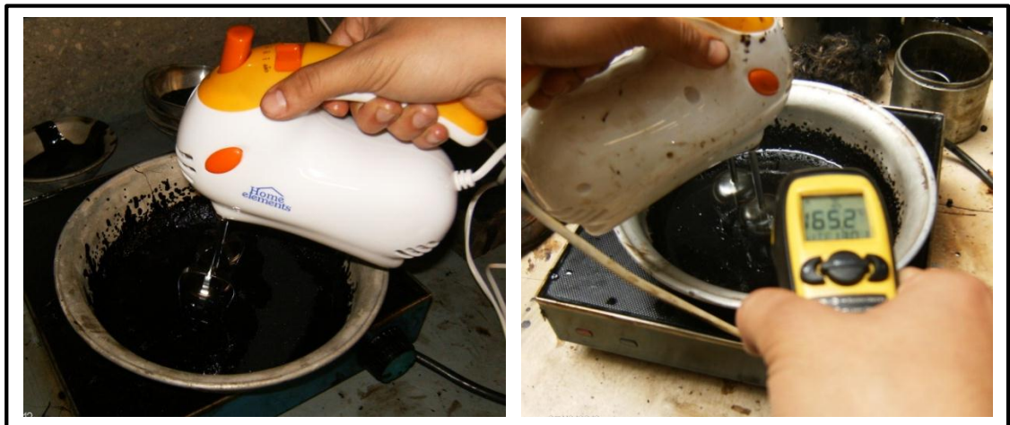
Figura 9. Proceso de mezclado en la adición de los polímeros.
