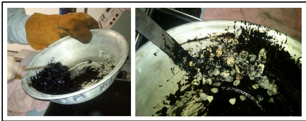
Figura 15. Ensayo de Stripping (Preparación de las muestras).
