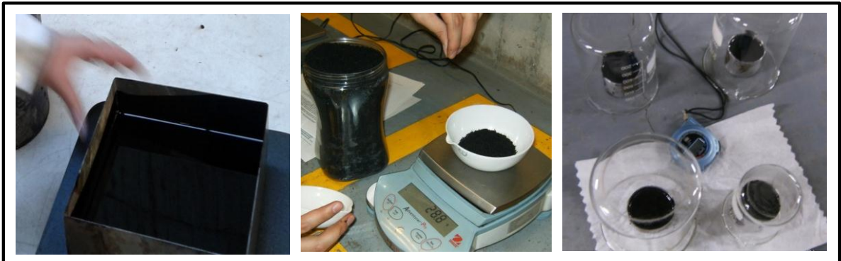
Figura 10. Ensayo de Penetración (preparación de las muestras).
