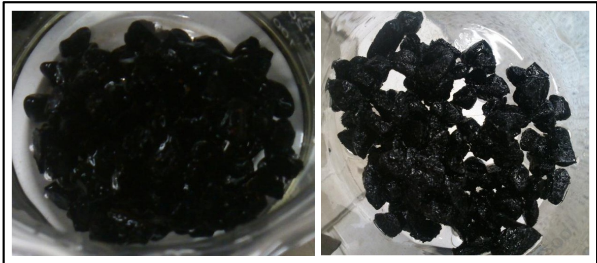
Figura 28, Ensayo de Stripping con asfalto 80-100 + GCR + 10%, 15%, 20% y 25% arcilla calcinada.
