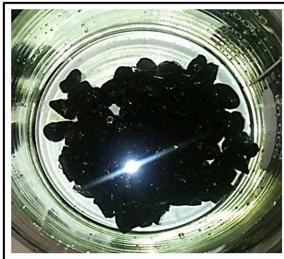
Figura 25, Ensayo de Stripping con asfalto 80-100 sin adiciones
