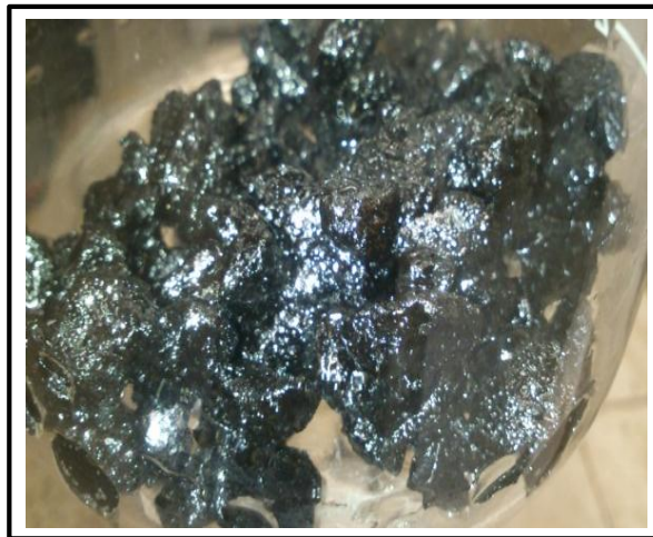
Figura 27, Ensayo de Stripping con asfalto 80/100 + GCR + 5% arcilla calcinada.
