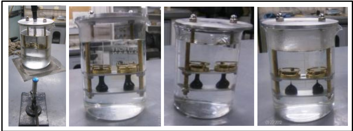
Figura 13. Ensayo de Punto de Ablandamiento (ejecución del ensayo).
