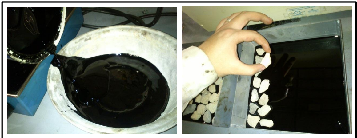
Figura 14. Ensayo de Bandeja de Adherencia (Preparación de las muestras).
