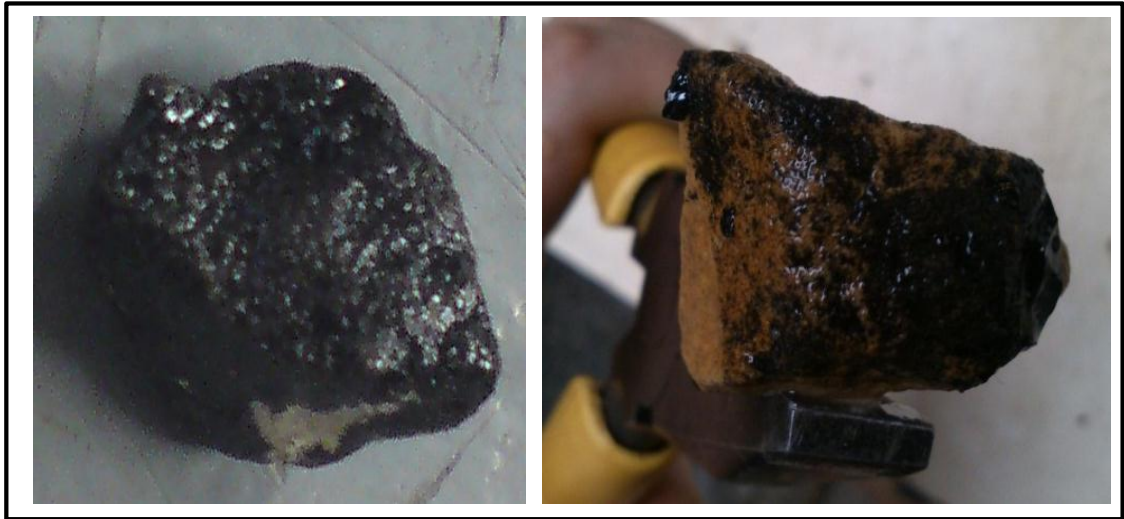
Figura 30, Ensayo de Bandeja de Adherencia con asfalto + GCR
