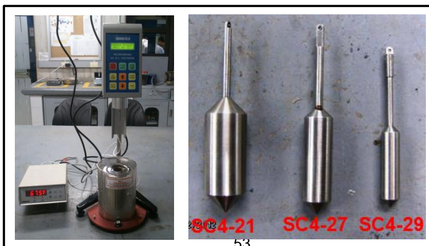
Figura 17. Montaje del Viscosidad Rotacional.
